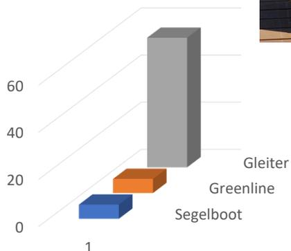
Der Marine Dieserverbrauch entspricht nach Messungen mit unserem Fahrverhalten etwa dem eines Segelbootes und nur ca. 10% eines fossil angetriebenen Motorbootes, selbstredend bei gleicher Geschwindigkeit.
